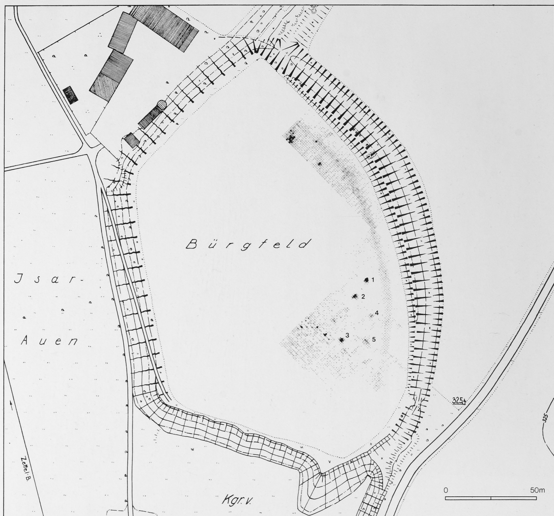
141 Der Burgstall bei Moos mit dem durch magnetische Prospektion erschlossenen älteren Grabenverlauf. Punktdichteschrift von 0,5 ha in Meterintervallen. Nr. 1–3 vermutlich Töpferöfen, Nr. 4 und 5 Öfen oder Gruben des römischen Kastellvicus.
