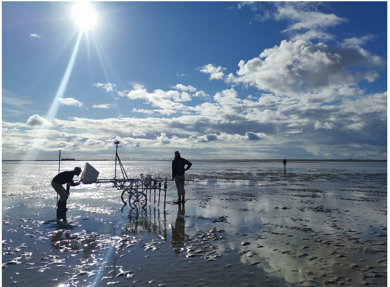
Abb. 5 Von zwei Personen handgeschobener Magnetik-Messwagen in Leichtbauweise der Universität Kiel für das systematische Erfassen magnetischer Anomalien auf Wattflächen. Die Ergebnisse der magnetischen Messungen zeigen sehr gute Ergebnisse bei der Erfassung überdeckter Siedlungsstrukturen im Watt und sind großflächig anwendbar. (Fotografie Ruth Blankenfeldt, © ZBSA/LEIZA)
