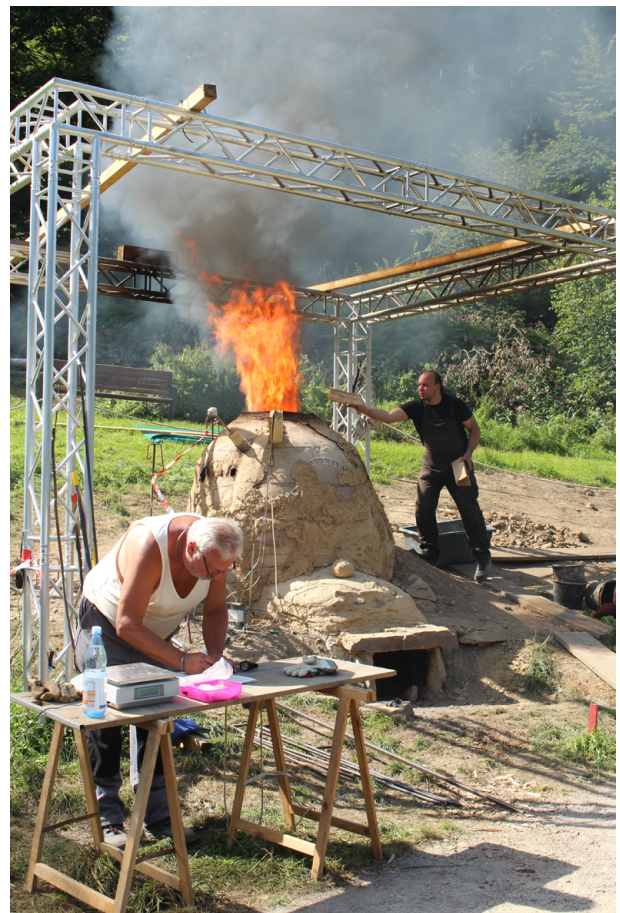
Ofennachbau: Während des Verhüttungsversuchs wurde genau dokumentiert, wann und wieviel Material (Erz, Holz) in den Ofen gegeben worden ist. Zudem wurden permanent die Temperatur- und Atmosphärenmessungen überwacht (Foto: LWL-Archäologie für Westfalen/M. Zeiler).
