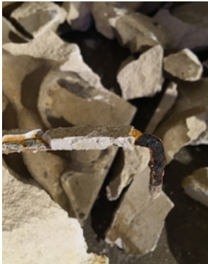
Juni 2019: Abgebrochene Kreuzblume, korrodierter Stahlanker
