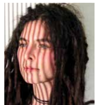
Abbildung 3: Zu scannende Person mit aufprojiziertem Streifenmuster
