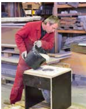
Spezialbeton wird in die Gussform gefüllt - ausgeschallter Rohling
