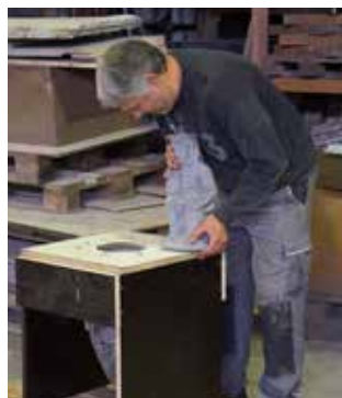
Spezialbeton wird in die Gussform gefüllt - ausgeschallter Rohling
