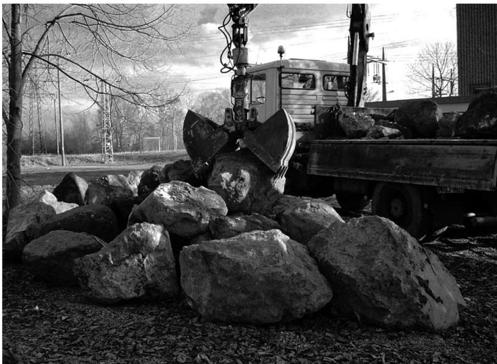
*Werksteinblöcke im Zwischenlager. Von den insgesamt 570 m<sup>3</sup> gelösten Steinen wurden 130 m<sup>3</sup> für die Weiterverarbeitung ausgewählt*
