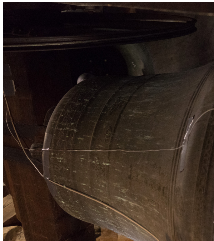
Messeinrichtung beim Läuten der Glocke 4. Glocke und Klöppel befinden sich im Scheitelpunkt der Schwingung beim Läuten.
