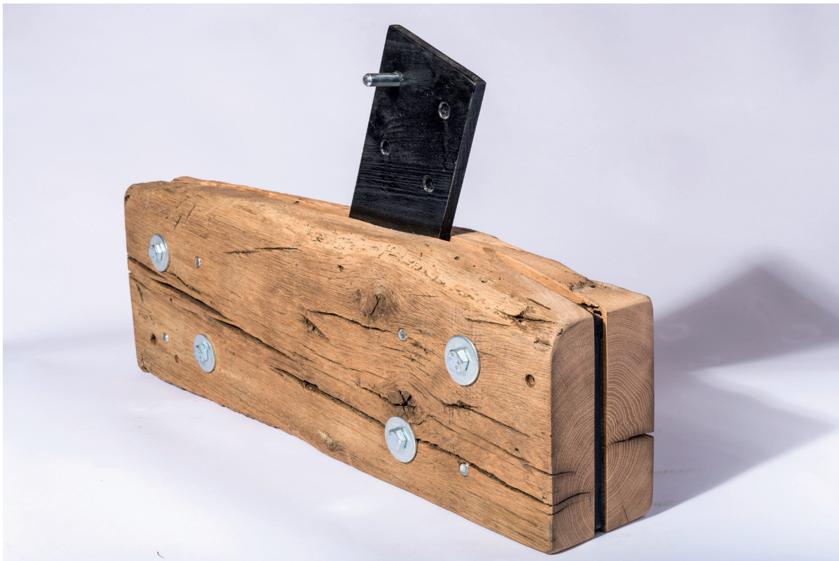
Konstruktionsdetail Holz - Metall - Verbindung
