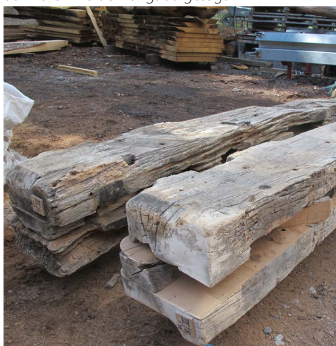
Schwellen werden längs aufgesägt
