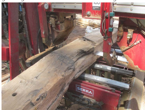
Schwellen werden längs aufgesägt
