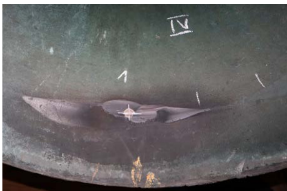
Abb. 3: Die neuen Anschlagflächen an Glocke 4 (links) und Glocke 6 (rechts)
