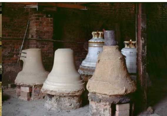
v.l.n.r.: Glockenkern, falsche Glocke, Lehm-mantel
