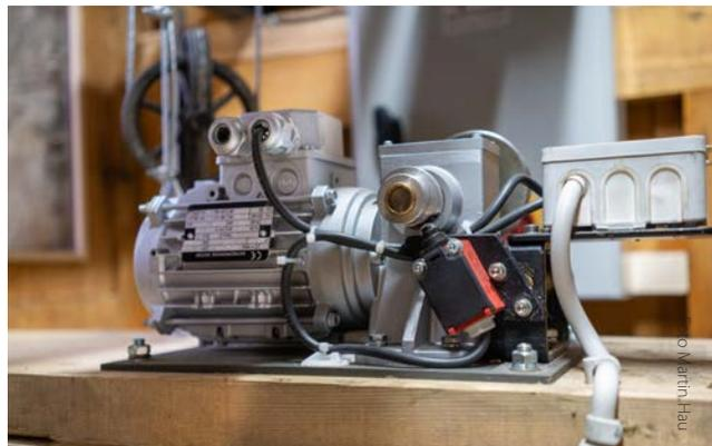
Abb. 16 Getriebemotor
