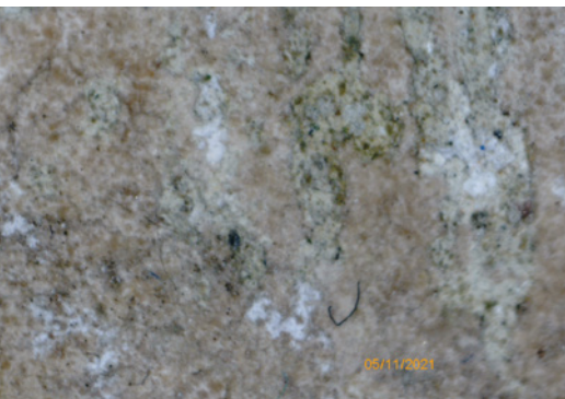
Abb. 9: Auflagen und Schmutz auf der Gesteinsoberfläche behindern eine Gesteinsansprache. (VM: lange Bildseite = 8 mm).
