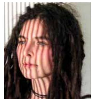
Abbildung 3: Zu scannende Person mit aufprojiziertem Streifenmuster
