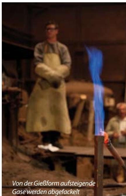
Von der Gießform aufsteigende Gase werden abgepackelt
