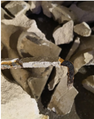
Juni 2019: Abgebrochene Kreuzblume, korrodierter Stahlanker
