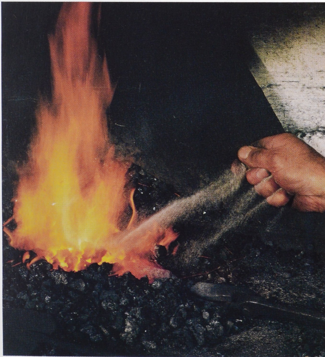
Abb. 3. Unter dem schützenden Glutmantel des Feuers hat sich das Schweißgut bis nahe des Schmelzpunktes erwärmt. Ohne das Paket dem Sauerstoff auszusetzen, wird das Flußmittel, Quarzsand, auf die schmelzende Oberfläche gestreut. Der Sand schmilzt sofort zu einer schützenden Glashaut. Gleichzeitig lösen sich die Eisenoxide und verbinden sich mit dem Quarzsand zu Schlacke. Eine gute Schlackenbildung ist eine der Voraussetzungen zu einer guten Feuerschweißung (Foto: Verf.).
