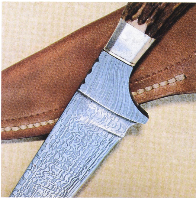
Abb. 8. Muster aus Streifenschichtung. Zur Musterbelebung wurde die Klinge mit einem Finnhammer ausgeschmiedet. Die Streifen aus den verschiedenen Werkstoffen sind vom Knauf bis zur Klingenspitze zu verfolgen; Herst.: Verf. (Foto: Verf.).
