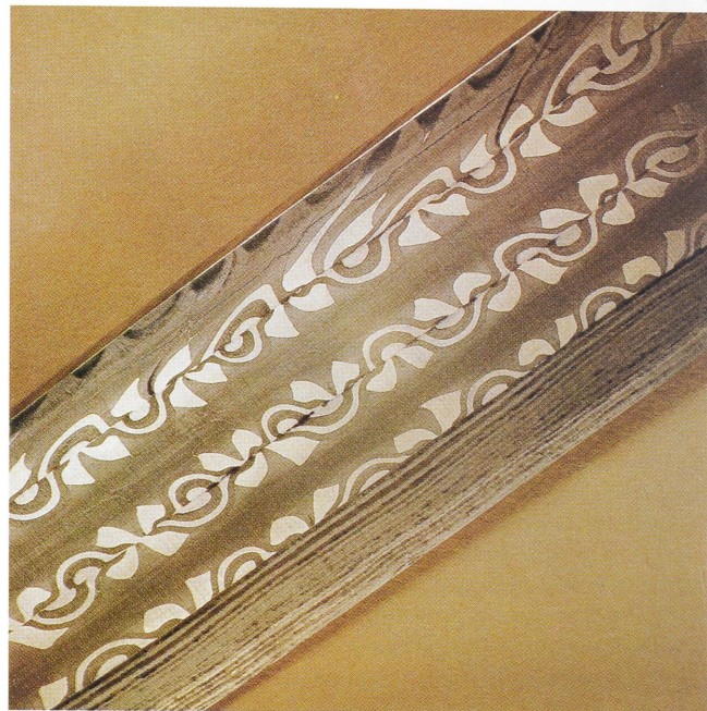
Abb. 9. Besonders schöne Kontraste entstehen bei Verwendung von phosphorreichen Eisen, sie zeichnen silberhell. Phosphor gilt als stahlfeindlich wegen seiner Versprödung und Kaltbrüchigkeit. Phosphorhärte wurde bei frühen Eisensorten genutzt. Heute findet man keine Eisensorten mehr, die für diese Musterbildung die erforderlichen hohen Phosphoranteile von 1,5–2% haben. Das für den Nachvollzug erforderliche Eisen wurde selbst erschmolzen; Herst.: Verf. (Foto: Verf.).
