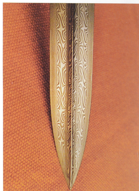
Abb. 13. Nachbildung einer Dolchklinge in Torsionstechnik. Drei Torsionsstränge mit schmalen Zwischenlagen zur Abgrenzung der Torsionsbahnen. Schneideleiste umlaufend aus Schichtstahl. Klinglänge 480 mm, vierseitig hohlgeschliffen mit Mittelgrat; Herst.: Verf. (Foto: Verf.).
