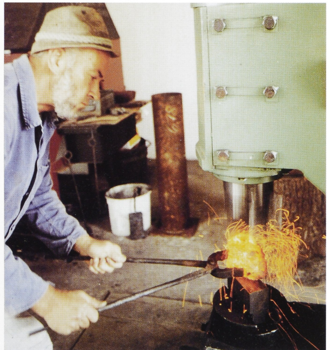
Abb. 4. Unter dem Luftschiemedehammer wird archäologisches Roh-eisen verdichtet und zusammengeschiedet. Das luppenartige Roh-eisen (Schwammeisen wegen seinem inhomogenen Zustand) stammt aus Bodenfunden vorchristlicher Eisengewinnung in Süd-Wales, England (Foto: Peter Crew).
