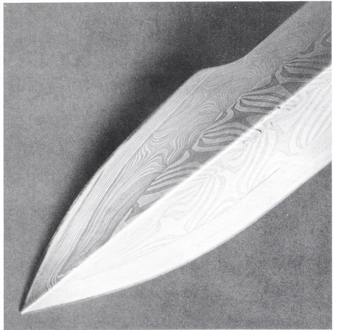
Abb. 2. Nachbildung einer Torsionsschwertklinge aus drei Torsionschienen und einer umlaufenden Schneideleiste aus Schichtstahl; Herst.: Verf. (Foto: Verf.).
