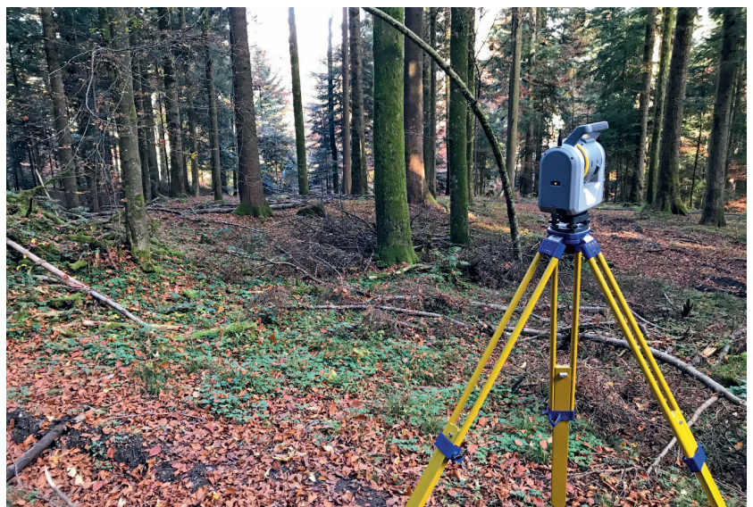
Abb. 12. Trachselwald BE, Chammenegg. Vermessung des Geländes mithilfe der Totalstation und des Laserscanners mit Unterstützung des Globalen Navigationssatellitensystems (GNSS) (Verf.).
