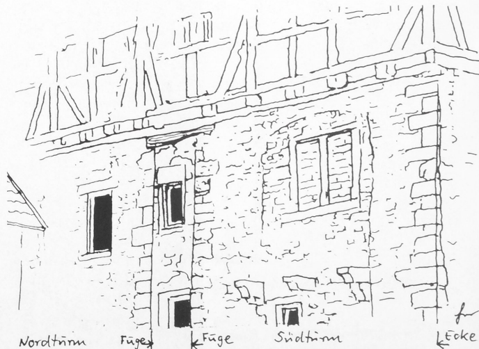
Abb. 12. Nachzeichnung der Abb. 11 zur Verdeutlichung der Eckquadern und der Mauerwerksfügen zwischen den Turnteilen.
