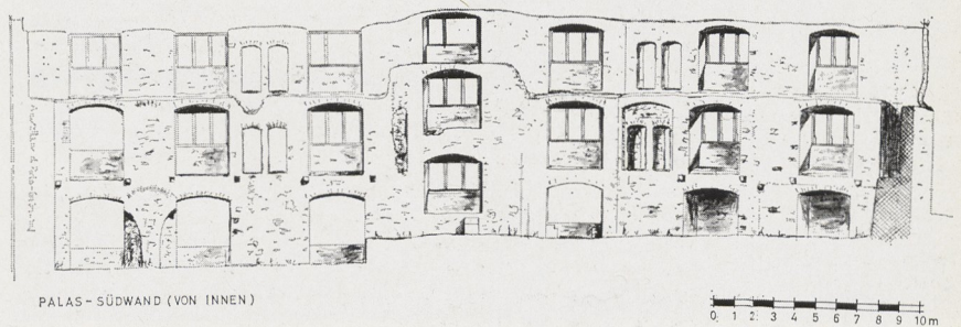
Abb. 17 Ruine Oppenheim: Außenmauer des Palas von innen gesehen
