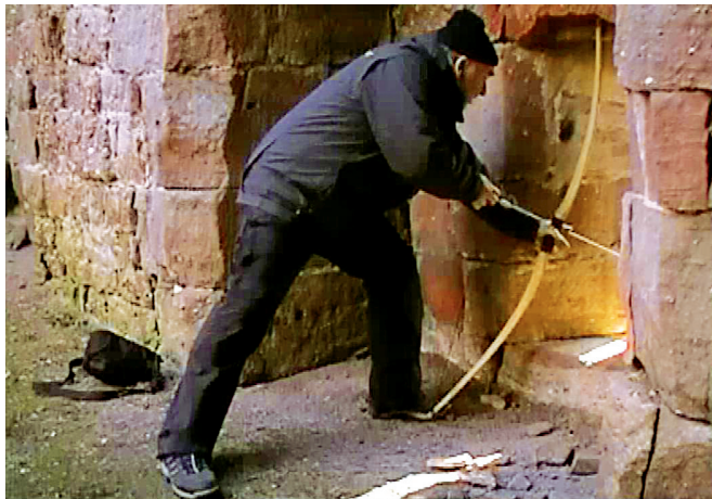
Abb. 10. Der Versuch auf Birkenfels zeigt deutlich, dass man mit dem Bogen nicht nahe genug an die Schießöffnung – hier Scharte Nummer 5 – herankommt, um sinnvoll zielen und schießen zu können (Foto: L. Bernges).
