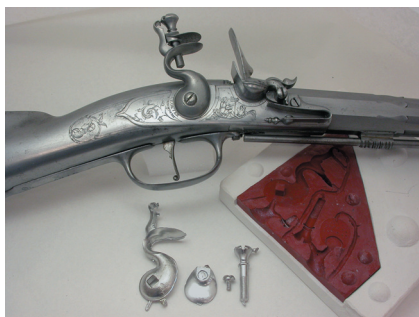
Abb. 2. Verschiedene Stadien der Ergänzung eines Hahns an der Vogelflinde GJA.1.50 (Büchsenmacher Cloeter, Mannheim, um 1680) (Kunstsammlungen der Veste Coburg).
