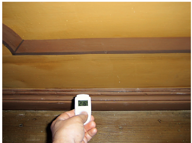
Abb. 21. und 22. Die Abstrahlleistung des verputzten Sockelkreislaufes kann mit einem IR-Thermometer gemessen werden.
