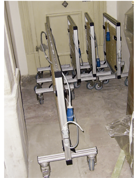
Abb. 30. und 31. Die Elektrostrahlplatten im Ersteinatz als Baustellenheizung (links) und im Sommerhalbjahr im Depot (rechts).
