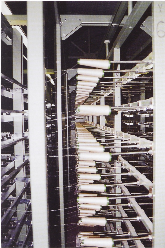
Abb. 2. (oben) Schärgeratter mit aufgesteckten Spulen, Abb. 3. (oben rechts) Details der Webmaschine und Abb. 4. (unten rechts) Gegenüberstellung (Fotos: Eschke).
