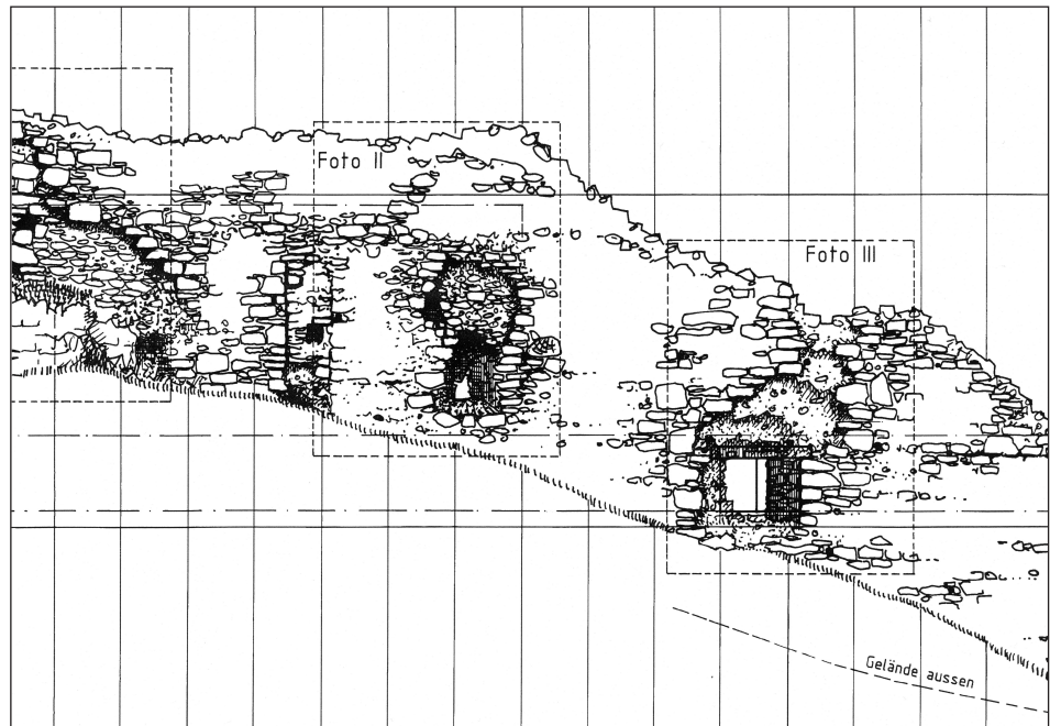
Abb. 19. Burg Melchingen, Süd-mauer, Innenansicht mit Blick gegen Süden, Ausschnitt aus dem Baugesuch von 1983, dieser Bauabschnitt wurde nicht ausgeführt (Baufaufnahme und Zeichnung: Verf.; die senkrechten Linien markieren jeweils 1 m Abstand).
