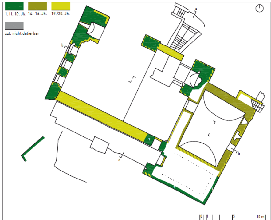
Abb. 11. Wohnbau, Grundriss des Erdgeschosses mit Baualterskartierung, nach der Bauaufnahme Hilfenhaus/Rudolph/Schmidt 5/2007 (Zeichnung: Verf., 2007).
