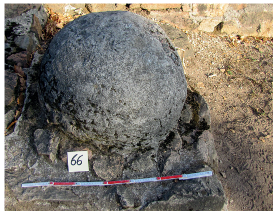
Büchsenstein der Großen Frankfurter Büchse aus Basalt. Durchmesser: 62 cm, Gewicht: nicht wiegbar, da in der Erde eingelassen und angemörtelt. Der Stein wurde gepickt und weist Verwitterungsspuren und Flechtenbewuchs auf (Foto: M. Kirchschlager, 2018).
