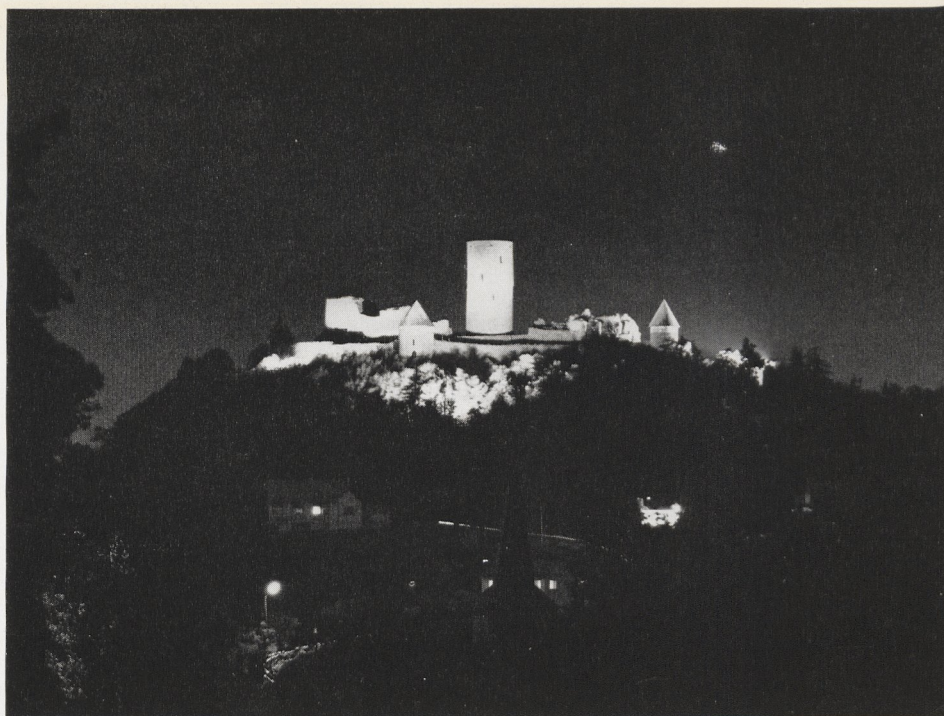
Abb. 1. Burgruine Nürburg. Die weithin sichtbare Nürburg, um die die weltbekannte Rennstrecke führt, wird mit 3 Hochleistungs-LICHTFLUTERN®, bestückt mit je einer Halogen-Metaldampflampe HQT 2000 W angestrahlt. Die Lichtfluter befinden sich in ca. 80 m Entfernung von den Mauern und ermöglichen so mit 3 Geräten die Anstrahlung der Burg von 3 Seiten und eines Teils des Berges
