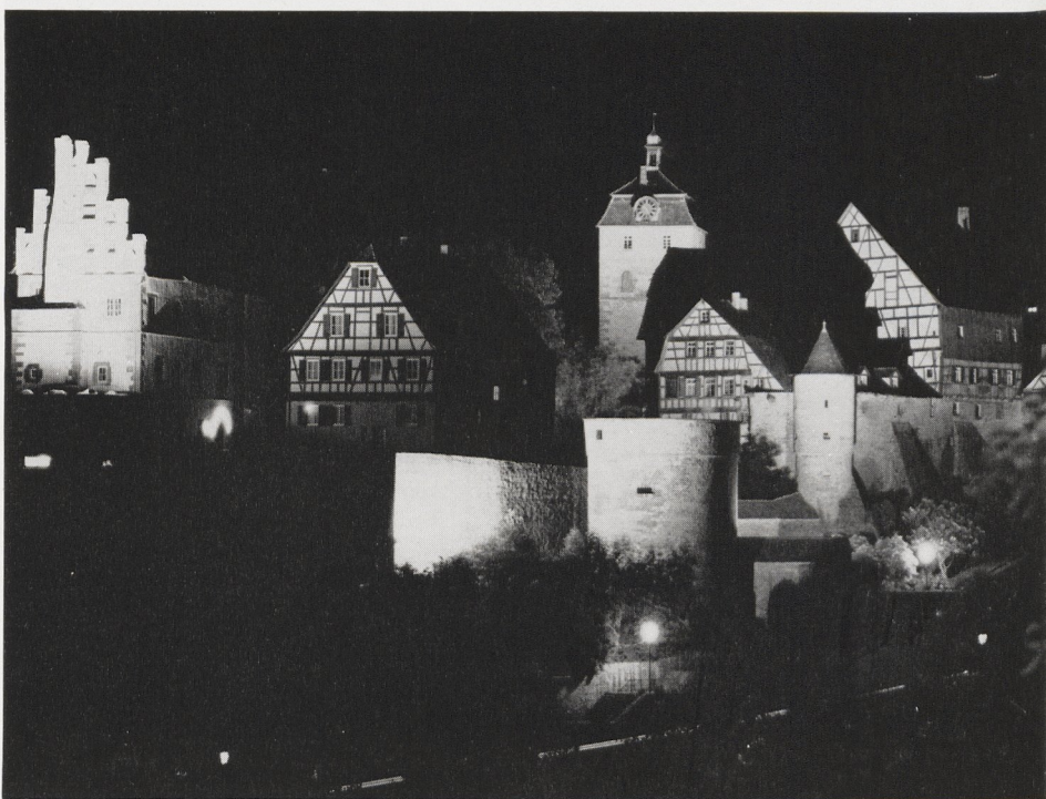
Abb. 2. Stadt Vellberg. Der Kern der Stadt Vellberg ist eine ehemalige Stadtveste mit 8 Bastionen und 4 Wehrtürmen. Um die Wiederherstellung und Erhaltung des mittelalterlichen Stadtbildes bemüht sich die Baugesellschaft „Stadtmauer“. Am imposantesten Teil der Anlage wurden 4 Hochleistungs-LICHTFLUTER® mit je einer Natriumdampf-Hochdrucklampe Na V-T 400 W zur Anstrahlung eingesetzt. Diese Lampen bringen das alte Mauerwerk besonders zur Geltung. Es ist daran gedacht, mit dem Fortschritt der Renovierungsarbeiten auch weitere Teile der Stadtbefestigung anzustrahlen
