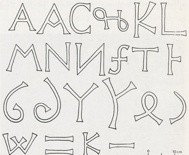
Abb. 5. Burg Hohbarr. Aufstellung der Doppelzeichen: A. Schichtenhöhenzeichen B. Steinmetzzeichen
