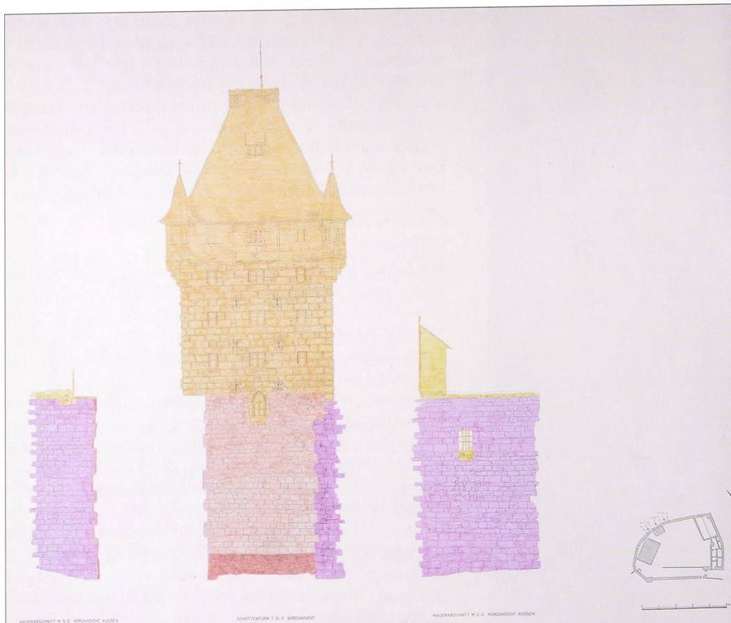
Abb. 10. Abenberg, „Schottenturm“, Feldansicht bzw. Westansicht. Bauphasen wie Abb. 3 (Zeichnung: Büro für Burgenforschung, 1996/Bildmessung gGmbH).
