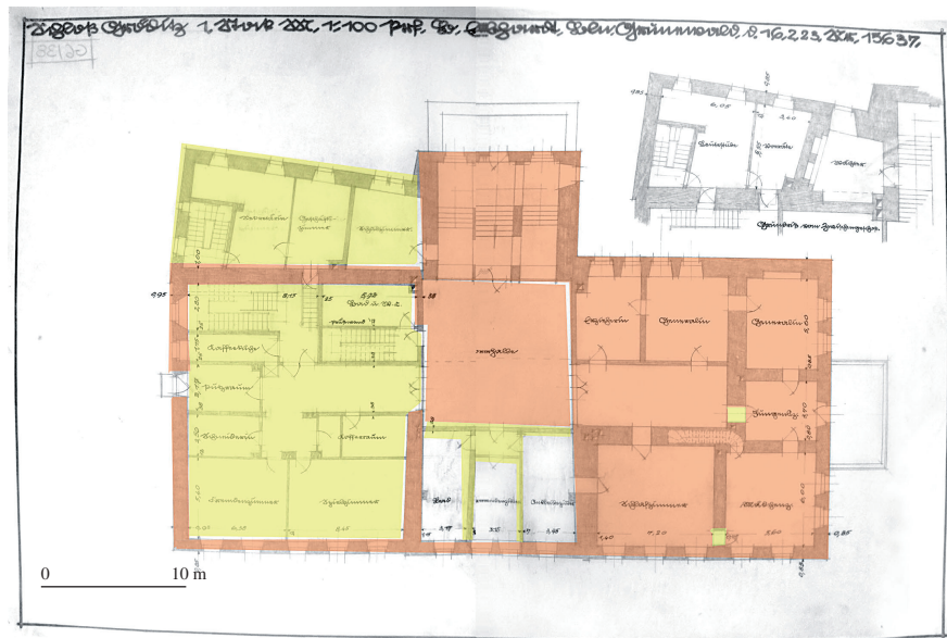
Abb. 15. Kennzeichnung der Altersschichten Obergeschoss (aus: DBV-Archiv, Plansammlung, Planmappe Gröditz, Plan Nr. 15637). Orange: 18. Jahrhundert. Gelb: Wiederaufbau erste Hälfte 20. Jahrhundert durch Ebhardt.
