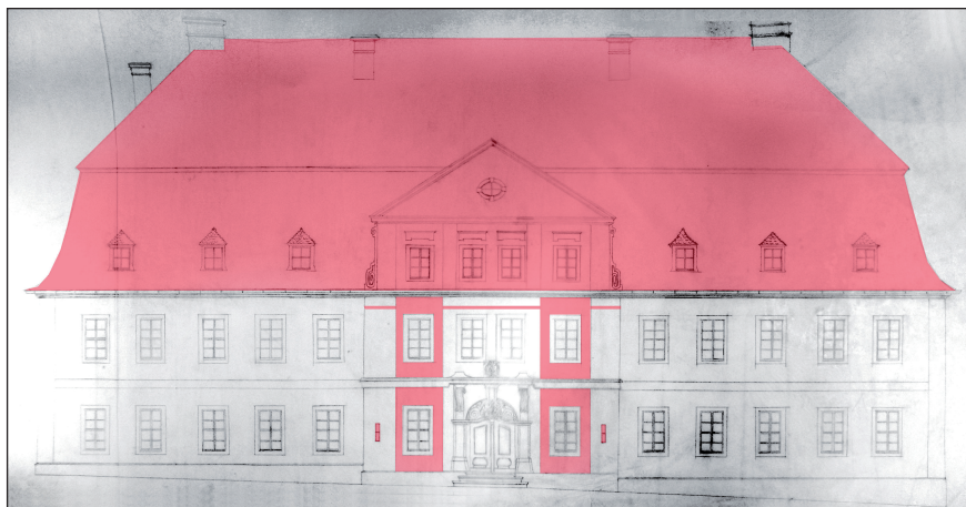
Abb. 7. Westfassade, Entwurf 6.3.1927, Plan 16236 – vermutlich der Ausführungsplan – mit Kennzeichnung der Veränderungen Eberhards gegenüber dem Bestand von 1922 (aus: DBV-Archiv, Plansammlung, Planmappe Gröditz).
