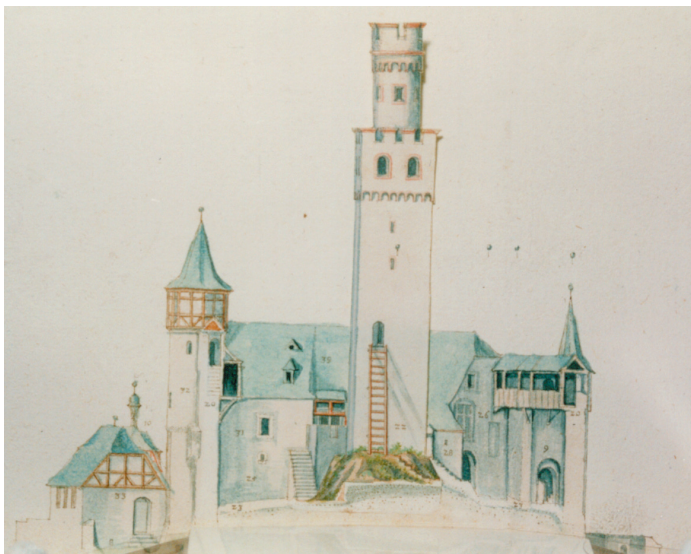
Abb. 1. Der Ausschnitt aus der Südansicht der Marksburg zeigt die Südfassade des Bergfrieds mit dem ursprünglichen Eingang zum Zugangsgeschoss des Turmes. Kolorierte Handzeichnung von W. Dilich, 1608 (Original Gesamthochschulbibliothek Kassel).
