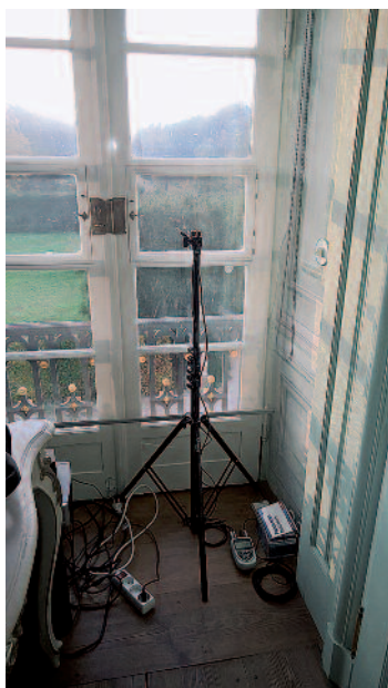
13 Fasanenschlösschen, Schloss Moritzburg, Messaufbau zur Bestimmung der vorhandenen UV-Schutzwirkung einer Folie
