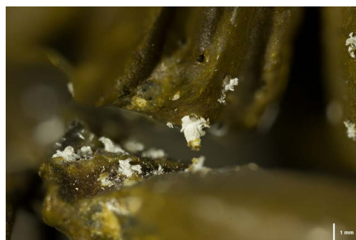
12 Makroskopische Aufnahme eines Bleikorrosionspunktes am Schweif eines Pferdes (Inv.-Nr. Ker 2690)
