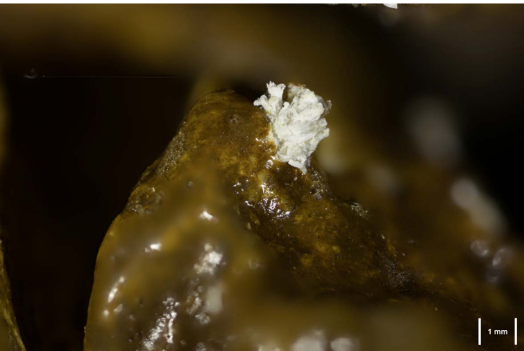
13 Makroskopische Aufnahme eines Bleikorrosionspunktes am Schweiß eines Pferdes (Inv.-Nr. Ker 2689)
