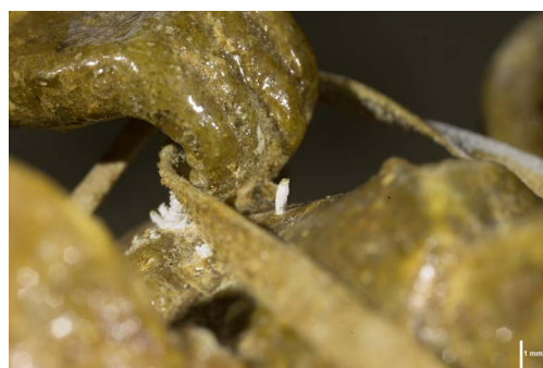
11 Bleikorrosion unter der Hand eines Reiters (Inv.-Nr. Ker 2699)
