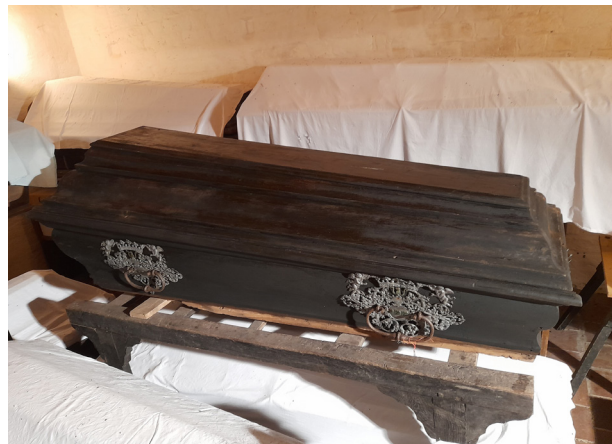
13 Sarg von C. E. V. Ramelow nach der Reinigung und Behandlung mit 2%iger Klucel® E-Lösung in Ethanol
