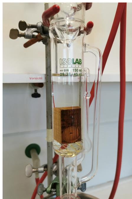
2 Labor-Soxhlet-Aufsatz mit Vollholzprüfkörper
