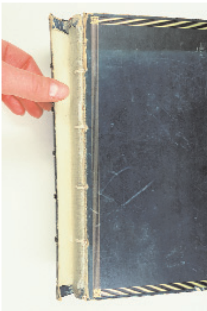
25 Blick in den hohlen Rücken nach dem Anschnüren
