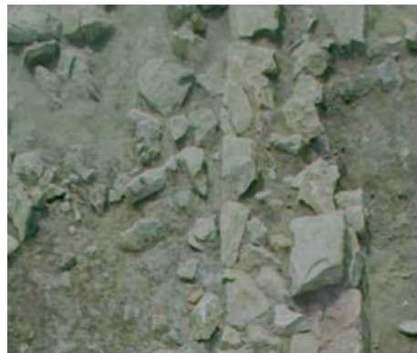
8a und 8b Kippung und Lageversatz nicht ebener Punkte. Links ein entzerrtes Foto aus annähernd Orthoposition. Rechts der selbe Ausschnitt aus einer entzerrten Schrägaufnahme
