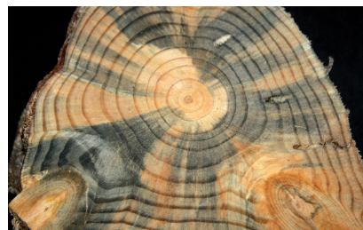
17 Querschnitt eines Baumstamms von „Blue Pine“ mit Fraßgängen des „Mountain pine beetle“ und streifenartigen blaugrauen Verfärbungen durch Bläuepilze
