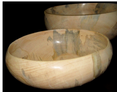
16 Zwei gedrechselte Schalen aus Pappelholz mit gelblichen und streifigen bläulichgrauen Verfärbungen durch Bläuepilze, Sara Robinson, Corvallis, 2011
