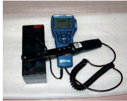
1 Bestimmung der Luftwechselrate mittels Tracer gas in Vitrinen des GNM
