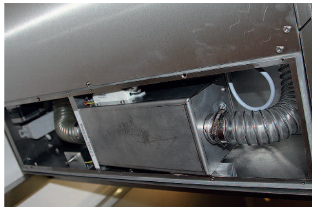
9 Schadstofffiltermodul zur individuellen Bestückung, dimmbare Querstromlüfter getrennt von Vitrineninnenraum und Klimaschublade
