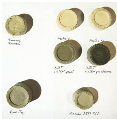
10 Ergänzungsmörtelproben für die Kittungen am schwedischen Sandstein, 2008
