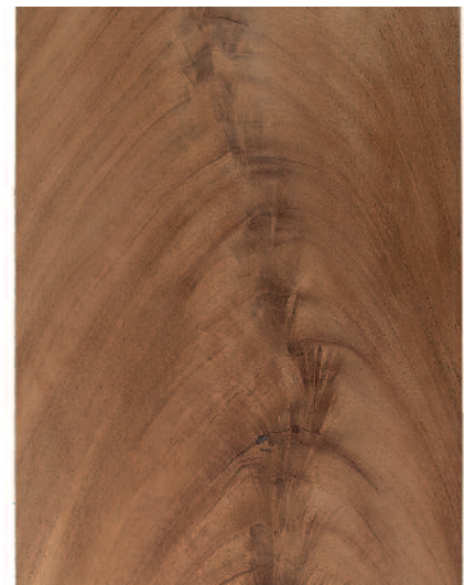
3 Probetafel mit Pyramidenmahagoni furniert, Oberfläche mit einer Ziehklinge geglättet, kein Überzug
