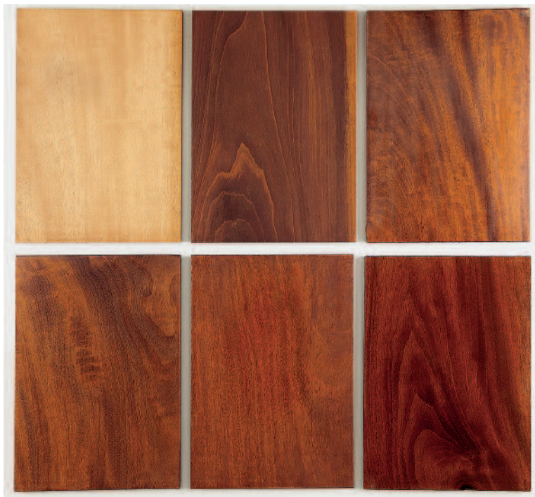
9 Probetafeln aus einem Seminar zum Ölschliff: Tafel links oben ohne Beschichtung; alle anderen Tafeln wurden nach historischen Rezepturen mit einer Mischung aus Leinöl und Drachenblut geschliffen; die Tafel rechts unten zusätzlich mit Schellackpolitur.
