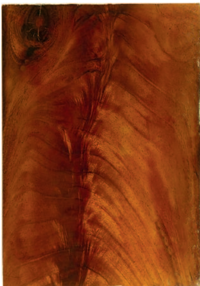
7 Probetafel Ölschliff ohne Farbzusätze (!) und Schellackpolitur: Im Vergleich zu Abbil- dung 3 zeigt sich, wie sehr die Oberflächen- behandlung bereits ohne färbende Sub- stanz das Mahagoni- Furnier anfeuert.
