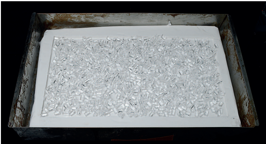
10 Silikonform mit Granulat vor dem Schmelzen
