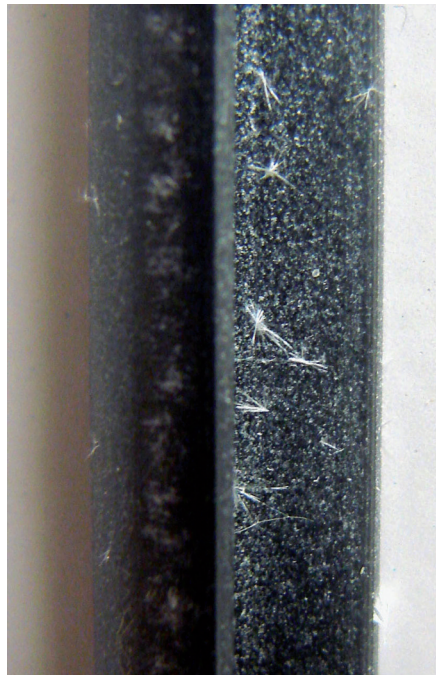
11 Nadelkristalle auf schwarzem Dichtungsprofil
