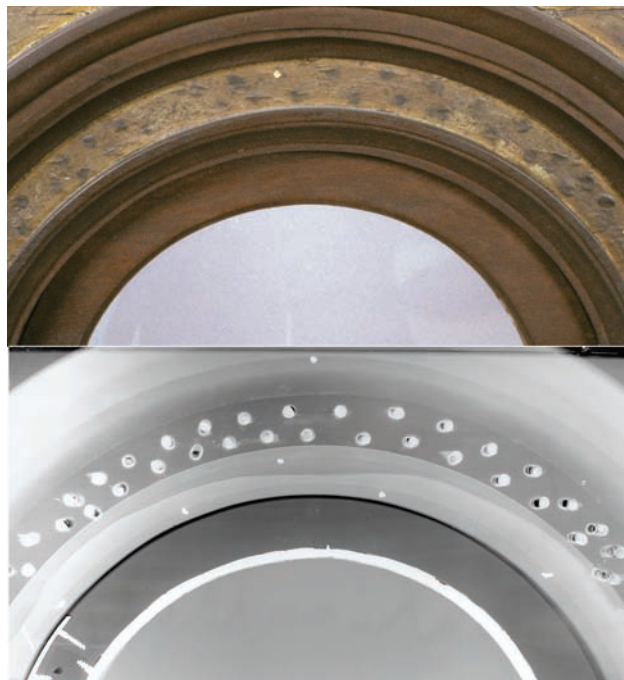
18 Detail des Giebels mit Metall- papier und Röntgenaufnahme im Vergleich: Die korrodierten punkt förmigen Bereiche und die Anordnung der Klanglöcher stimmen überein.
