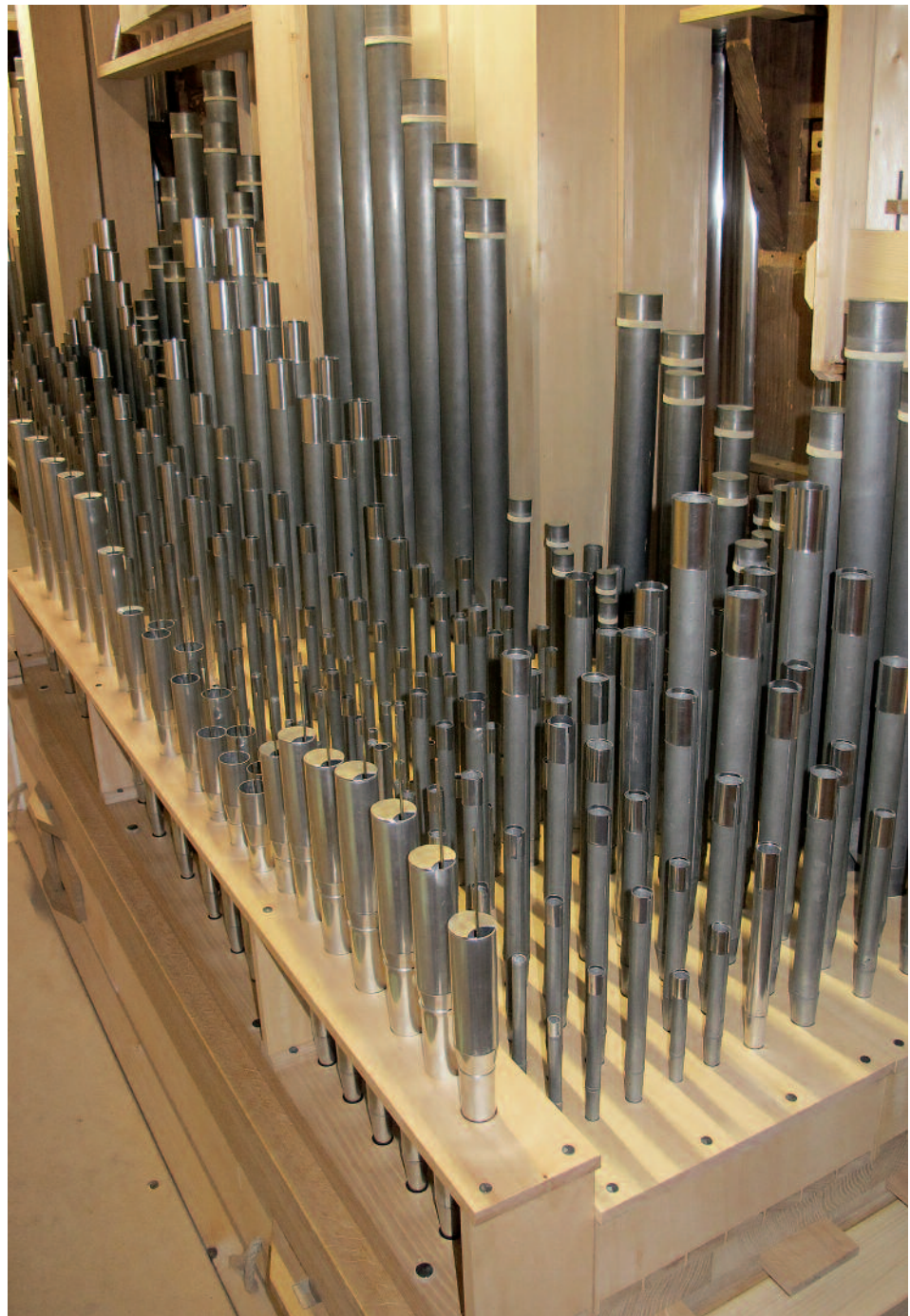
15 Angelängte und mit Stimmrings verlängerte Pfeifen, in vorderer Reihe die Vox humana
