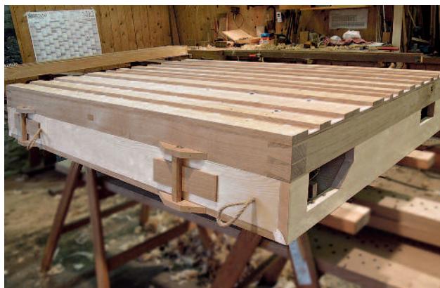
11 Windlade mit Eichenholzrahmen, Spunddeckel mit Hanfseilschlaufen
