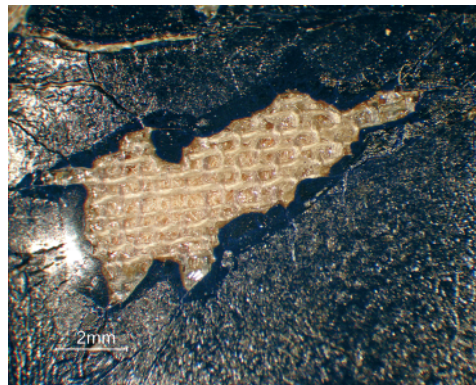
15 Fehlstelle nach dem Aufsie- geln von BEVA® 371 Film
