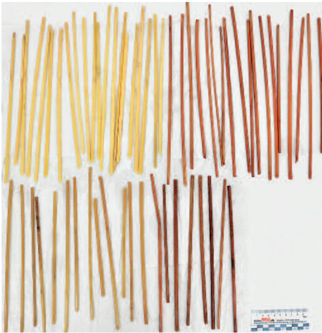
2 Farblicher Unterschied zwischen in Alaunwasser eingelegtem Stroh (oben) und in Alaunwasser gekochtem Stroh (unten)
