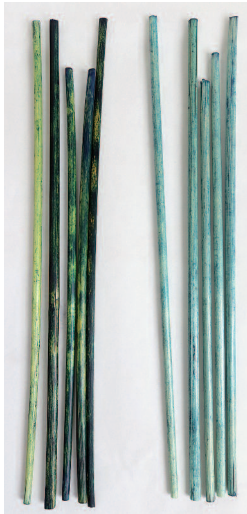
8 Mit Alaun vorbehandeltes (links) und unbehandeltes Stroh (rechts) in einer Indigo-Küpe gefärbt
