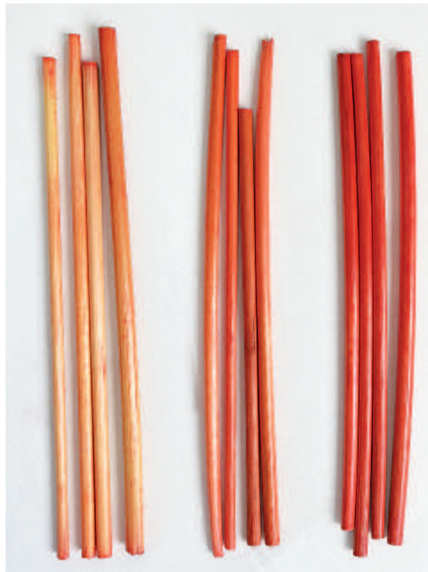
5 Vergleich des Färberefolgs mit Rotholz: (v. l. n. r.) unbehandeltes Stroh, 23 Stunden gefärbt; mit Alaun vorbehandeltes Stroh, 2–3 Stunden gefärbt; mit Alaun vorbehandeltes Stroh, 23 Stunden gefärbt
