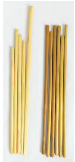
2 Farblicher Unterschied zwischen in Alaunwasser eingelegtem Stroh (oben) und in Alaunwasser gekochtem Stroh (unten)
