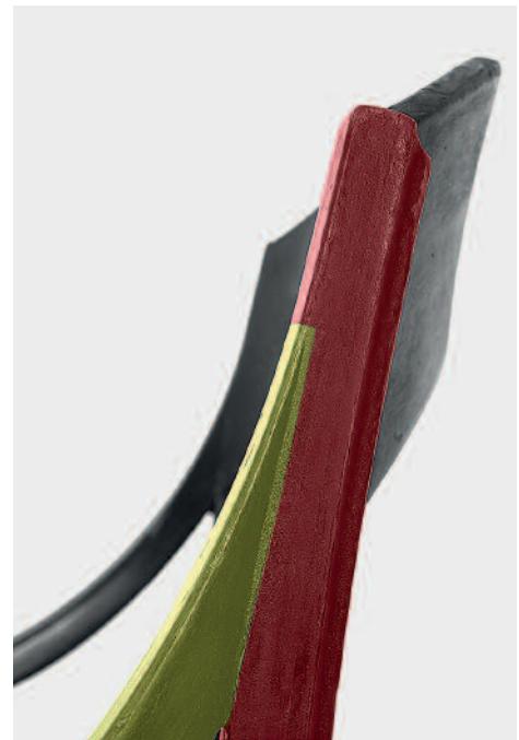
13 Röntgenbild RB 4620, schematische Darstellung der Konstruktion, Verbindung Rückenlehne und Lehnholm
