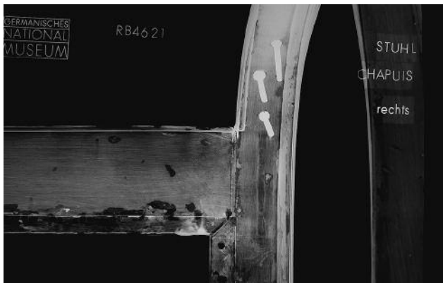
8 Röntgenbild RB 4621, Verbindung hinteres Sitzrahmenbrett mit Lehn- holm
