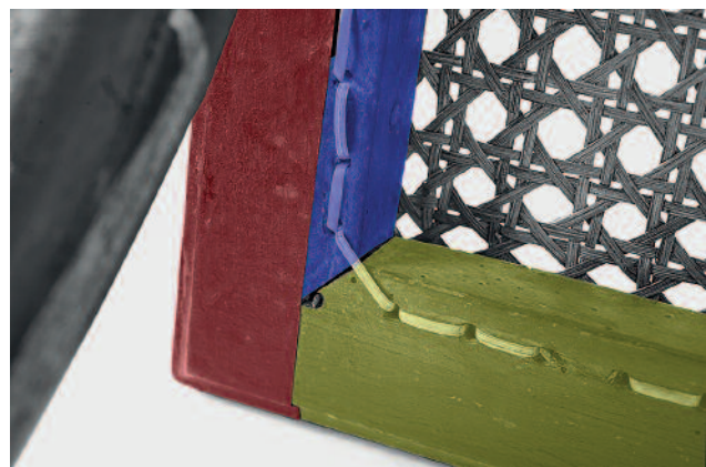
11 Armlehnstuhl, schematische Darstellung der Unterseite der Sitzfläche, rechte Vorderseite
